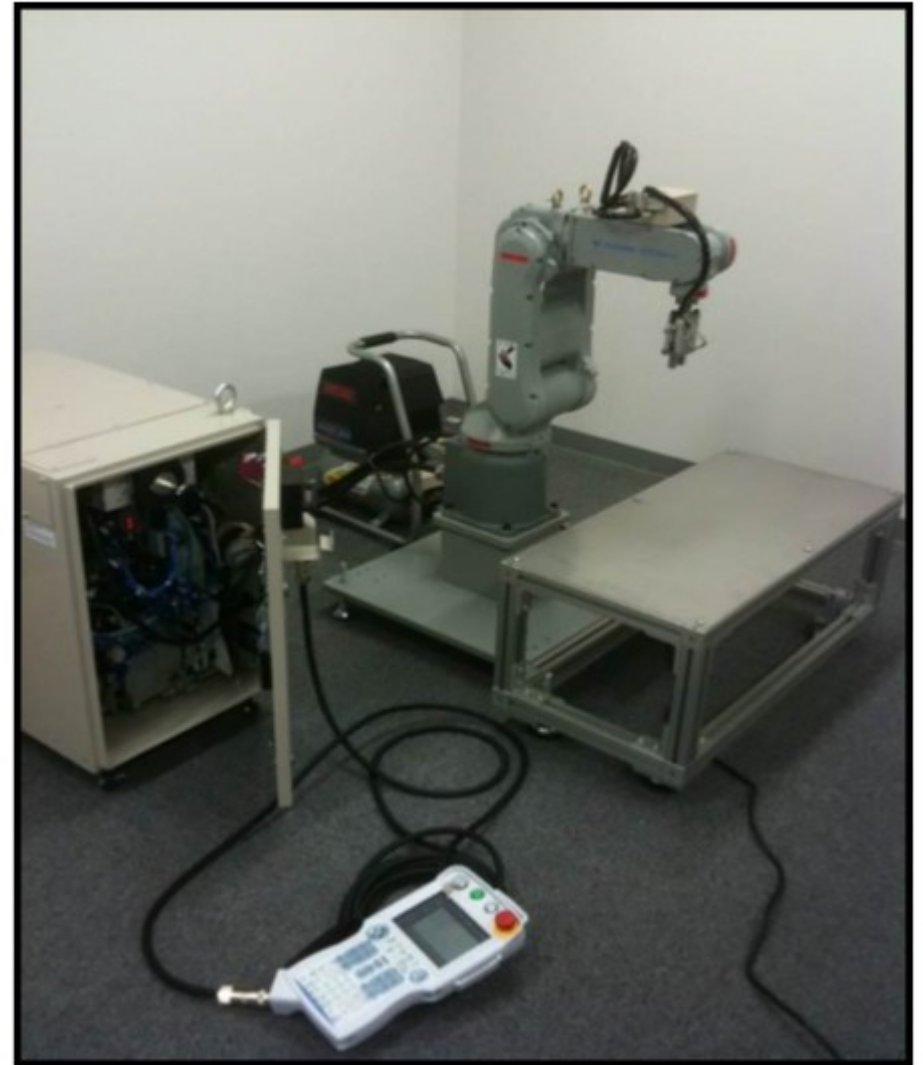
リアルタイムOS (VxWorks) 上で 軽量Rubyが動作する多関節ロボット
